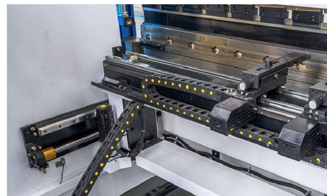
四轴后挡料装置 X+R+Z1+Z2
